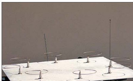
Bild 3: Verbesserte Version mit acht nun horizontal polarisierten Antennen
