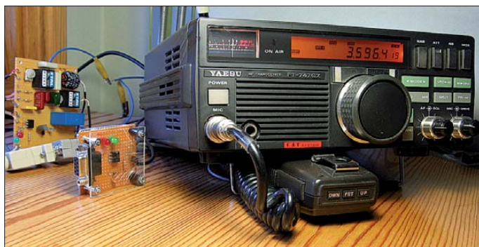
Bild 1: Selbst ein betagter Yaesu FT-747GX ist zum Versenden von E-Mails mit Winmor geeignet. Für die Bedienung über RMS Express reicht eine serielle Schnittstelle aus. Links sind Soundkarten-Interface sowie CAT- und PTT-Steuerung zu sehen.
