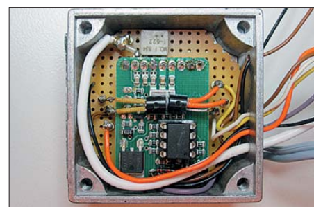
Bild 14: Oszillatoreinheit im fertig montierten Aluminiumgehäuse
