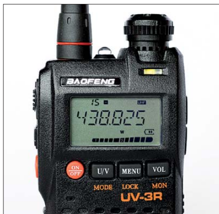
Bild 5: LC-Display und Bedienelemente; oben der Drehknopf mit mechanischer Sperre, links daneben die Taschenlampen-LED
