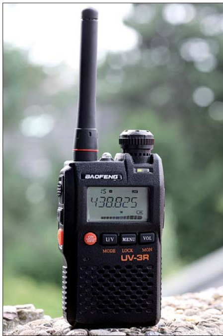
Bild 1: Dualbander für 2 m und 70 cm, Baofeng UV-3R; Ähnlichkeit zum VX-3 unverkennbar!
