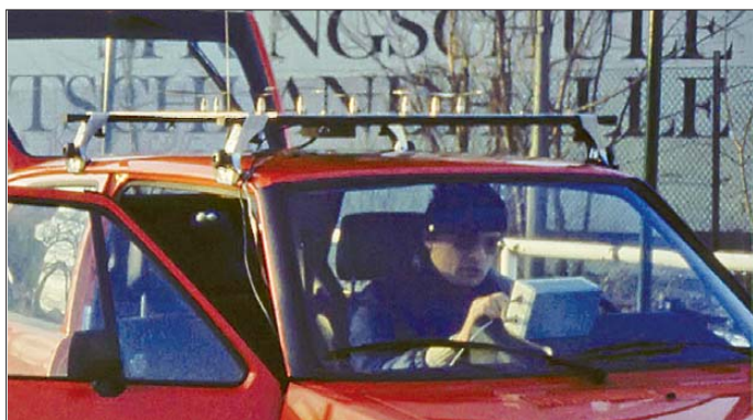
Bild 1: Der nach Anregungen von DL9SU gebaute MC6802-Doppler-Peiler im praktischen Einsatz; die Aufnahme entstand 1982.
