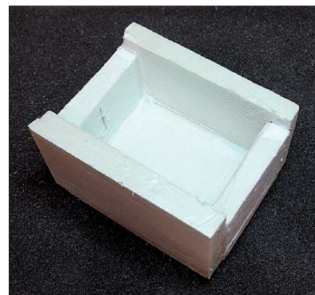
Bild 15: Die Wärmekammer besteht aus Polystyrolschaumstoff.
