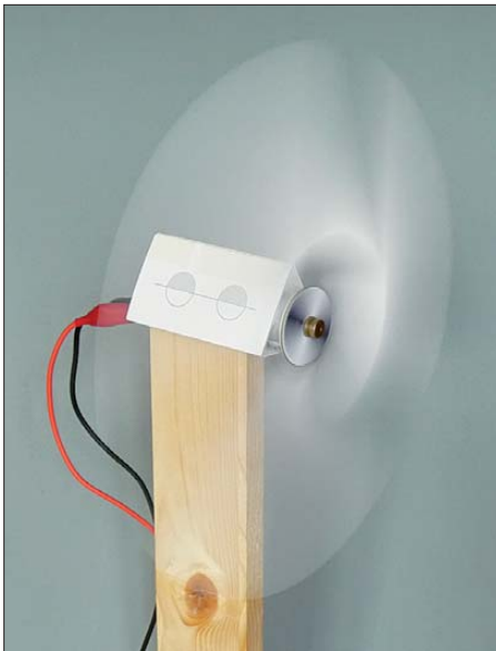
Bild 2: Der Flügelrotor kommt zwar beim Anblasen mit einem Fön ordentlich auf Touren, doch eine allzu große Ausgangsleistung des Generators sollte man nicht erwarten.
