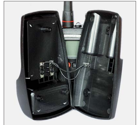
Bild 3: Die mitgelieferte Ladeschale reicht die Spannung vom Steckernetzteil ohne Ladeelektronik einfach an den Akkumulator weiter, sodass ihr Einsatz nicht zu empfehlen ist.
