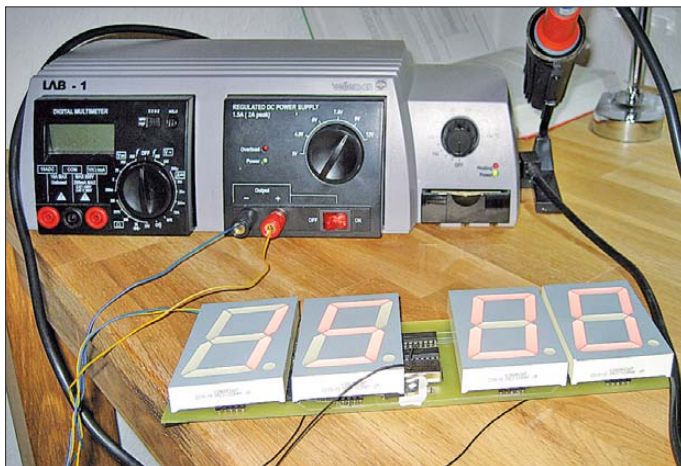
Bild 14: Anschluss der Schaltung an ein Labornetzgerät Fotos: Krypczyk
