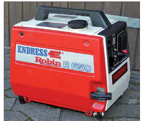
Bild 2: Das Kleinaggregat von Endress/Honda liefert 2 A bei 230 V und 8 A für das Laden von 12-V-Akkumulatoren.
