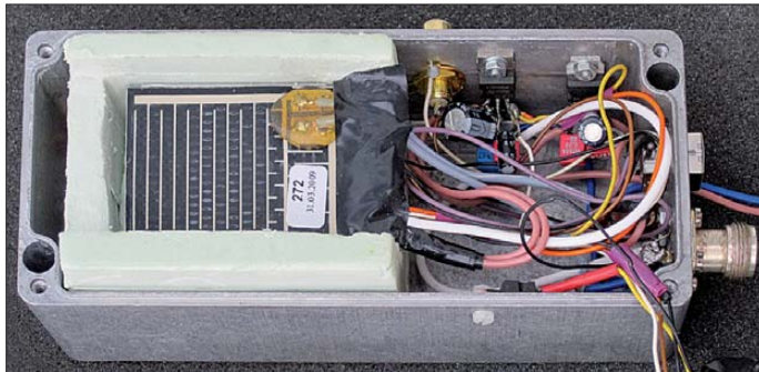
Bild 18: Die kleine Reglerplatine wird zwischen zwei 10 mm dicke Polystyrolschaumstoffplatten gepresst.
