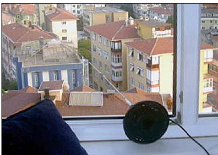
Kaum zu erkennen, aber gleichwohl für DX via E S sehr effizient: der 5/8-λ-Strahler auf der Fensterbank bei TA1D. Foto: TA1D
