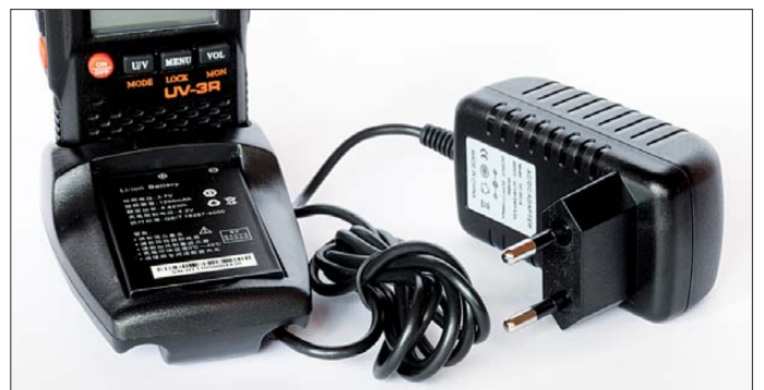
Bild 2: Zum Lieferumfang gehören eine einfache Ladeschale und ein Steckernetzteil, über das sich der Akkumulator direkt auch im Funkgerät laden lässt.
