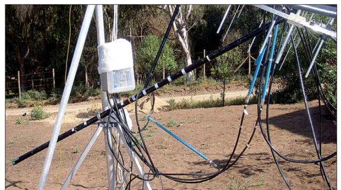
Bild 6: Die Schubstange für die Elevations-einstellung
