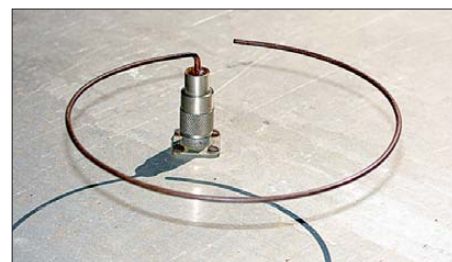
Bild 4: Detailansicht einer der acht horizontal polarisierten Ringantennen
