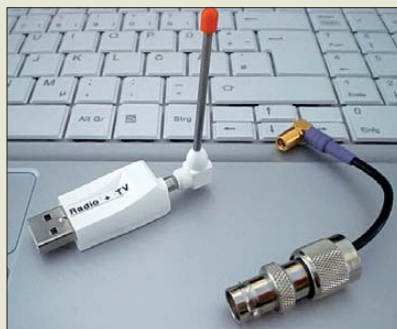
An den Weltempfänger in Form eines USB-Sticks lassen sich über die BNC-Buchse auch größere Antennen anschließen.
